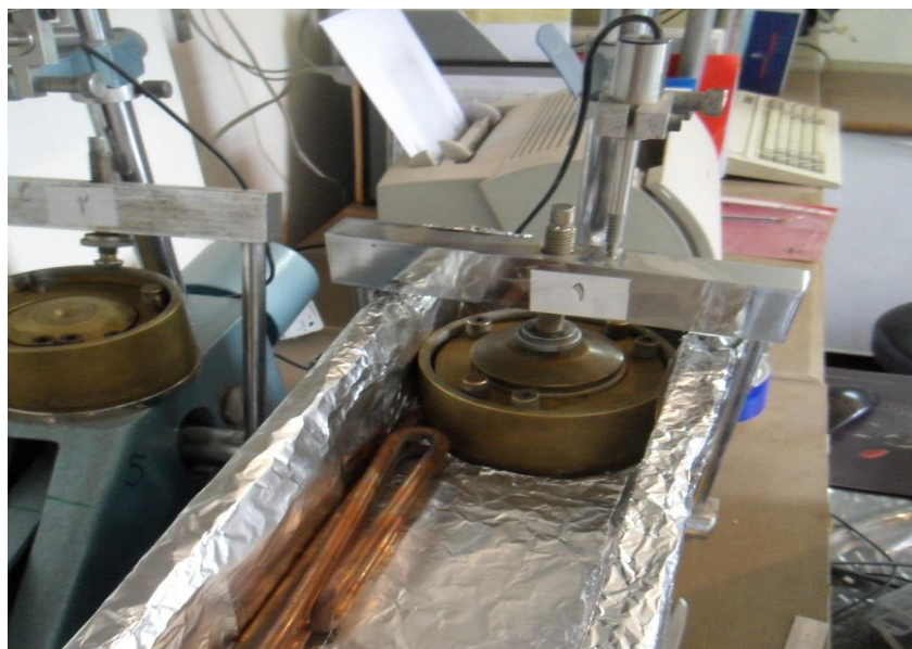
شکل شماره ۶. نمای داخلی دستگاه تحکیم با قابلیت کنترل دما
