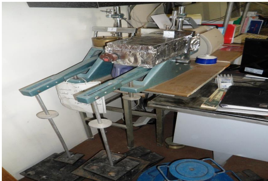
شکل شماره ۷. نمای خارجی دستگاه تحکیم با قابلیت کنترل دما (ساخته شده در شرکت ژرفابین خاک و سازه)
