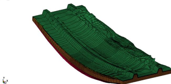
شکل ۲۱- شکل تغییر شکل یافته RSP بعد از برخورد موج انفجار
